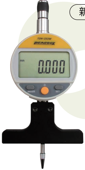
T2N-255W 最小表示量 0.001mm 測定範囲 20mm
