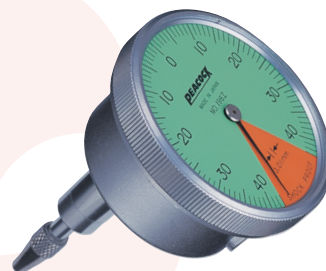
196Z 目量 0.01mm 測定範囲 0.8mm ●指針1回転未満タイプ ●測定子 (X-112)
